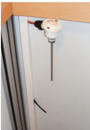
Fig.1 : Photo illustrant un capteur thermique à l'intérieur d'un caisson de la marque Cryoclinic Systems. [6]
